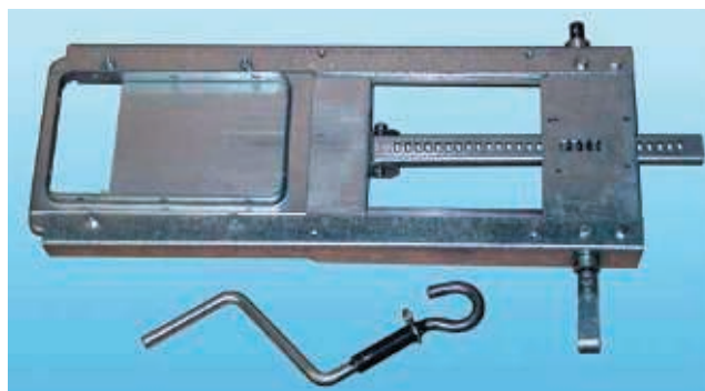
Actionneur à glissière du cribleur manuel (Remarque : la poignée a été raccourcie pour les besoins de la photo.)
