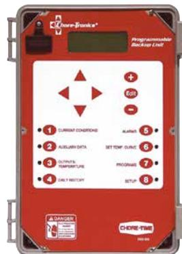
Entrez la courbe de température de votre poulailler pour que le PBU de Chore-Time ajuste automatiquement les sorties de refroidissement et de chauffage de secours. Ce système vous évite de devoir réinitialiser fréquemment les thermostats mécaniques. Se connecte aux boîtiers de secours standards ou étendus. D'autres options de secours sont également disponibles.
