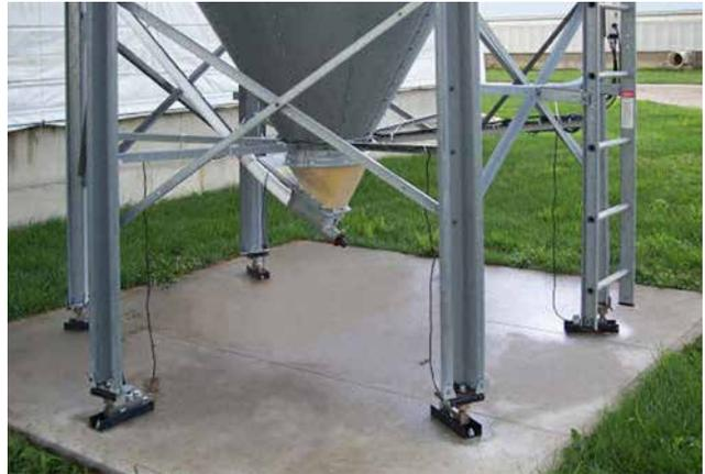
Le système à inventaire pour aliments intégré de Chore-Time, avec connectivité des cellules de mesure, permet une gestion et une surveillance économiques de l'aliment stocké dans les silos à aliments de la ferme.
